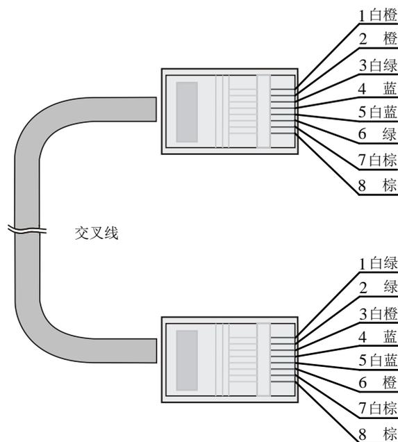
使用以太网双绞线连接设备时,应根据所连接的RJ45以太网口类型选择以太网双绞线的类型。RJ45以太网口分为MDI口和MDIX口两种类型,MDI和MDIX口各引脚功能分配情况如表C-3和表C-4所示。
