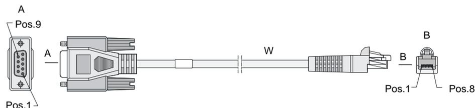
表C-1 配置电缆连接关系
